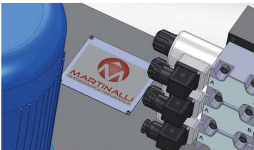
In alto schema del banco di pressurizzazione automatizzato per test valvole fino a 1500 bar.
